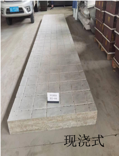
图 2-2 多孔隙投石机混凝土路面
