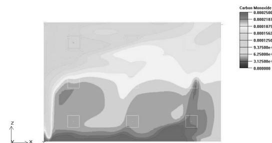
图10 Y=1.7m平面有毒烟气分布云图
